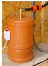
Fig. 4 - The MBAZEL-2007 micro-barometer.
